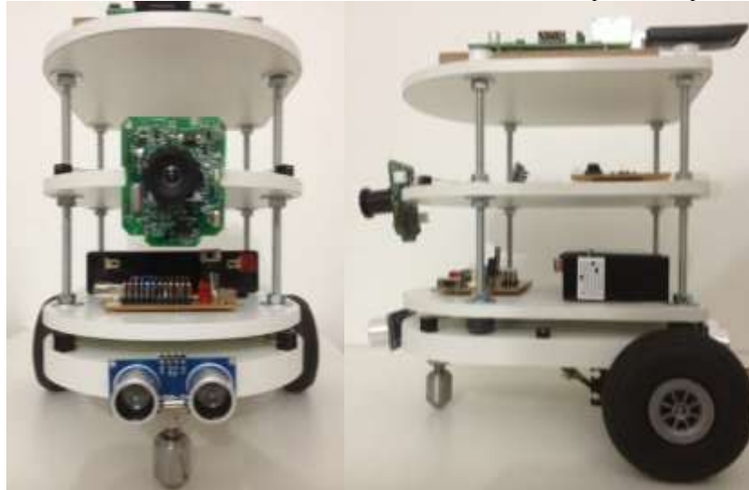
Figura 3 – Vistas frontal e lateral do robô móvel montado com todos os periféricos posicionados
