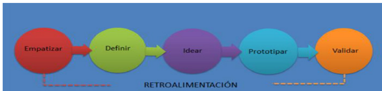
Figura 1 - Pasos para el proceso de diseño Fuente: Doorley, Holcomb, Klebahn, Segovia y Utley (2018).
