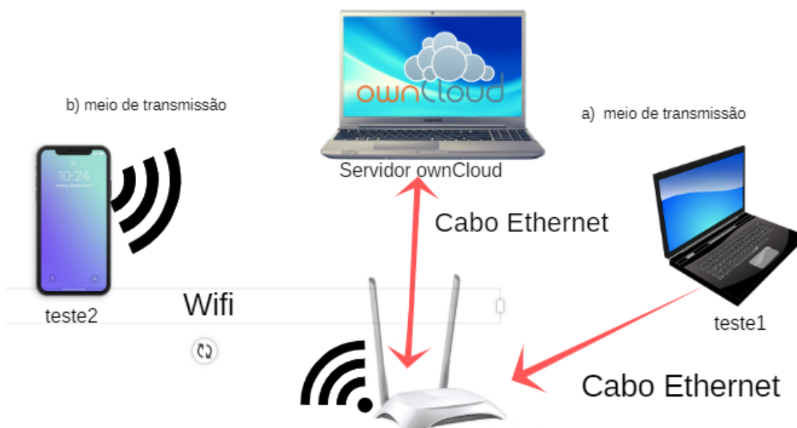
Figura 3: Meio de transmissão utilizado na transmissão dos dados
