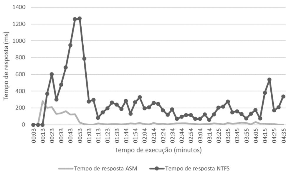
**Figura 5. Comparativo do tempo de resposta médio das máquinas S1 e S2 durante a execução do teste**
