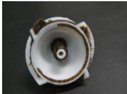
Figura 7. Em destaque o material de suporte na cor marrom antes de sua remoção no processo de prototipagem de FDM.
