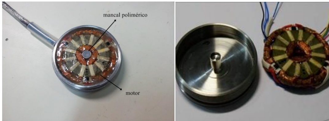
Figura 4. Motor desenvolvido para a BCI.
