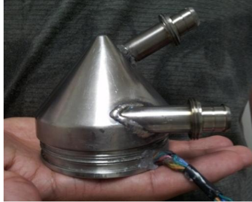
Figura 10. Protótipo em titânio da BCI utilizado no teste.
