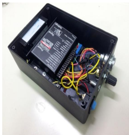
Figura 5. Controlador MAXON 1-Q-EC Amplifier DEC 50/5.
