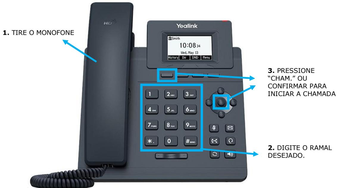
Para realizar uma chama **INTERNA** (para ramais dentro do sistema VOiP), retire o monofone do aparelho, digite o ramal desejado no teclado numérico e aperte o botão "**Cham.**" ou o botão "**confirmar**". Você também pode aguardar um instante e o telefone realizará a discagem automaticamente.
