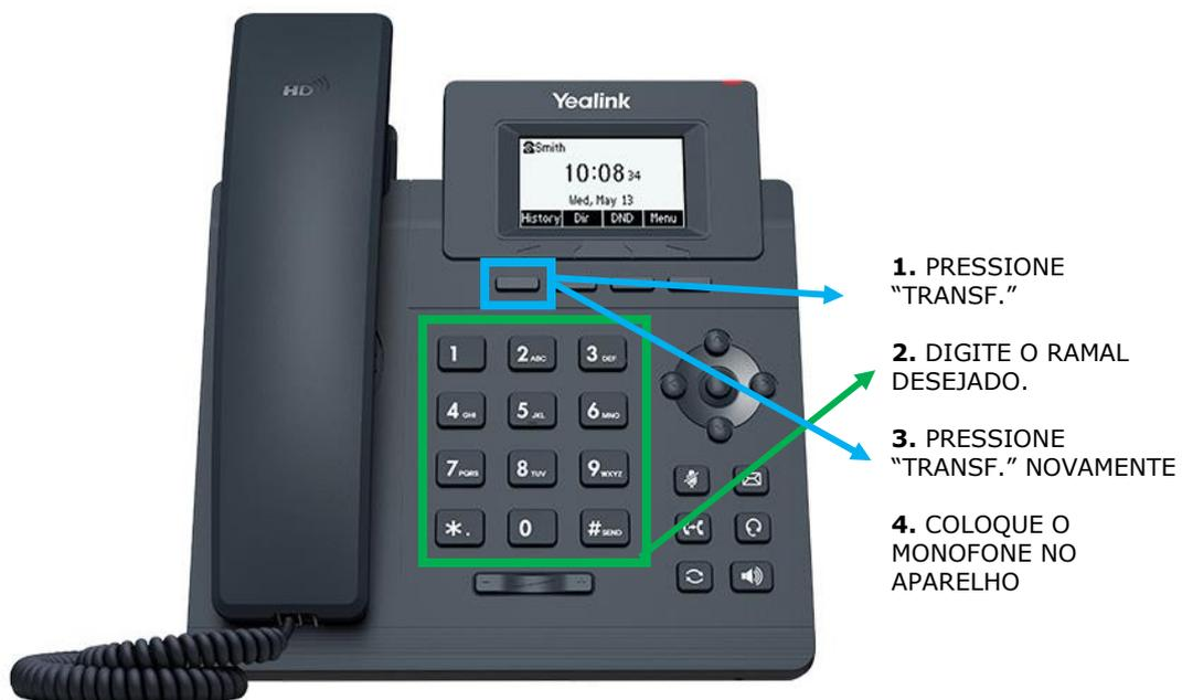
Para transferir uma ligação para outro ramal de forma direta (transferência cega), pressione o botão "**Transf.**", digite o ramal desejado no teclado numérico e pressione o botão "**Transf.**" novamente. A chamada será automaticamente transferida para o novo ramal e o telefone de origem ficará mudo. Coloque o monofone no aparelho.
