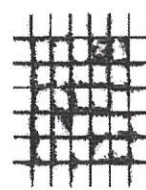
Gr 3 Área da película destacada, cerca de 35 % da área quadriculada
