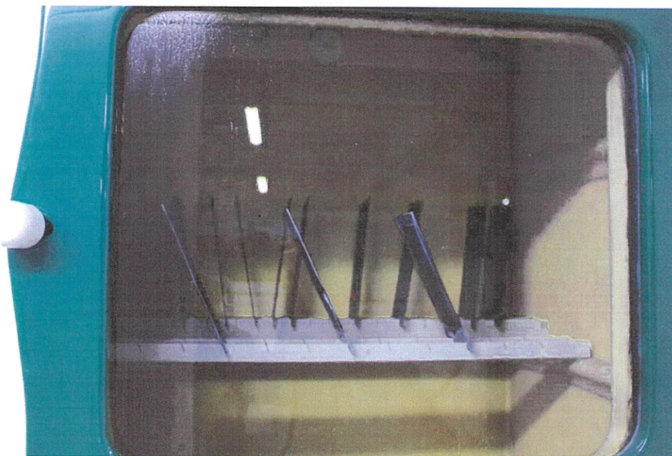
Disposição da amostra na câmara de ensaio.
