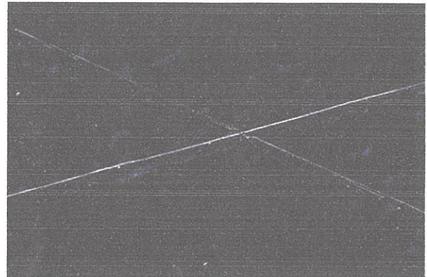
Segundo teste de aderência realizado no CPS 2. Classificação X_0/Y_0 (isento de destacamento).
