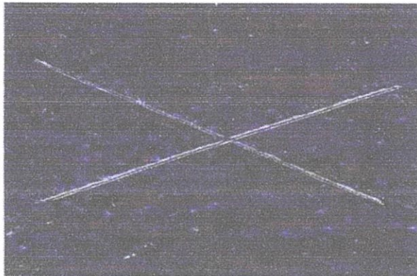
Primeiro teste de aderência realizado no CPS 1. Classificação X_0/Y_0 (isento de destacamento).
