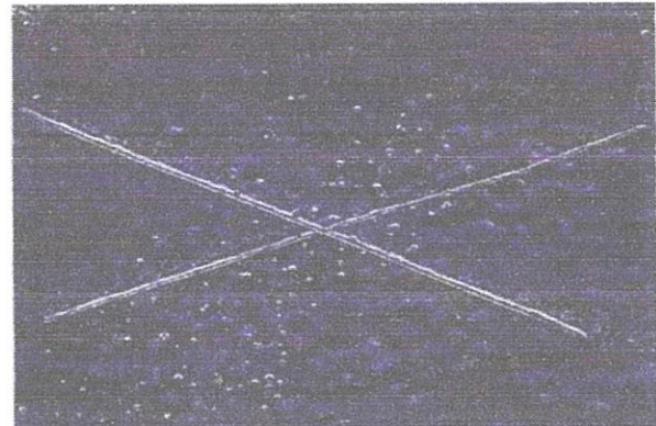
Segundo teste de aderência realizado no CPS 1. Classificação X_0/Y_0 (isento de destacamento).
