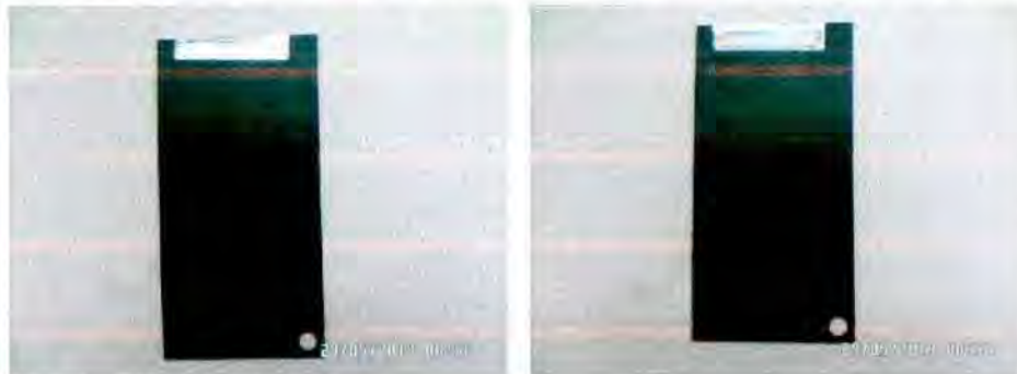
Antes do início dos ensaios amostras sem pontos de corrosão.
