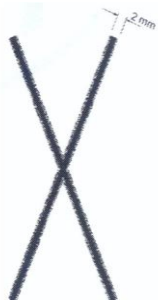
X 2 – Destacamento acima de 1 mm até 2 mm ao longo das incisões
