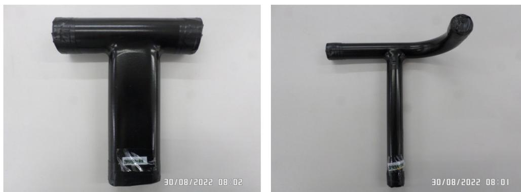
Após as 300 horas as amostras foram analisadas e não foram encontrados indícios de corrosão
