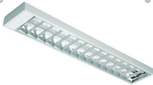
Luminária industrial tipo pendente com instalação em perfilado, com corpo em chapa de aço com pintura eletrostática na cor branca; refletor em alumínio anodizado de alto brilho (rendimento mínimo de 83%); alojamento do reator no próprio corpo; equipada com porta-lâmpada antivibratório em policarbonato com trava de segurança e proteção contra aquecimento nos contatos, para duas lâmpadas fluorescentes tubulares LED 20W.
