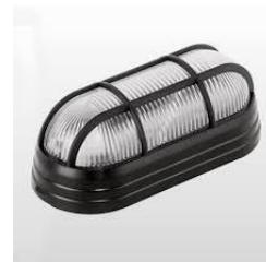
Bloco autônomo de iluminação de emergência (rota de fuga) na tensão indicada, com bateria com autonomia mínima de 1 hora equipado com duas lâmpadas de no mínimo 12 W ou equivalência em fluxo luminoso LED. Esse sistema será alimentado por circuito de força específico a partir do quadro terminal mais próximo;
