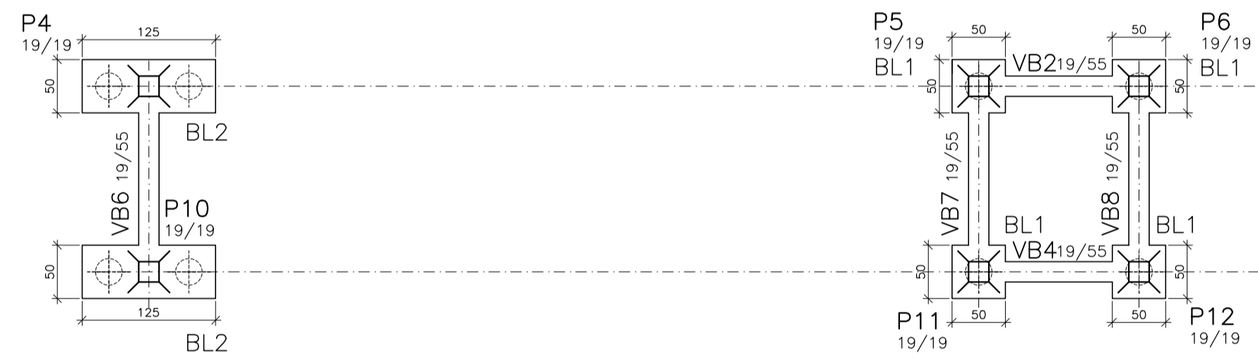
RAMPA E ESCADA 1 FORMA DA FUNDAÇÃO
