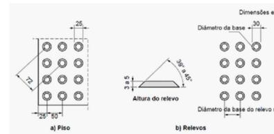
Figura 62 – Sinalização tátil de alerta e relevos táteis de alerta instalados no
