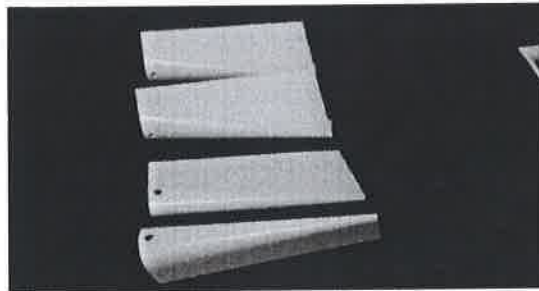
Vista das placas após dobramento sobre o mandril cônico
