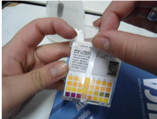
Figura 11 – Medição do pH
