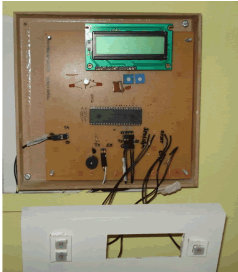
Figura 26: Hardware do nó Controlador Central
