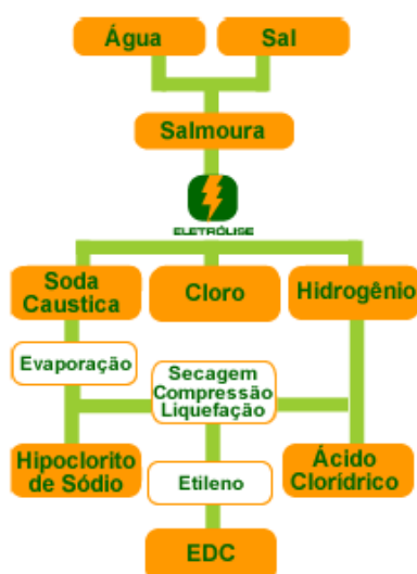
Figura 10 - Processo Produtivo da Carbocloro Fonte: Carbocloro, 2007
