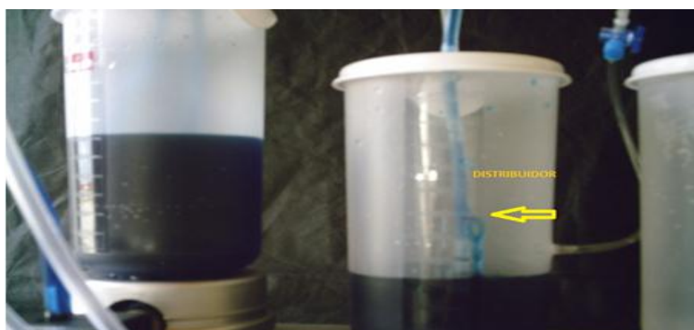
Figura 22 (c): Transferência da solução “água e azul de metileno” do misturador ao reator 1, fazendo uso do tubo distribuidor
