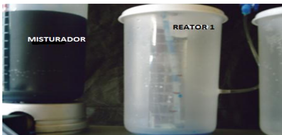
Figura 22 (b): Adição de traçador - solução aquosa de azul de metileno - ao misturador e a completa mistura.
