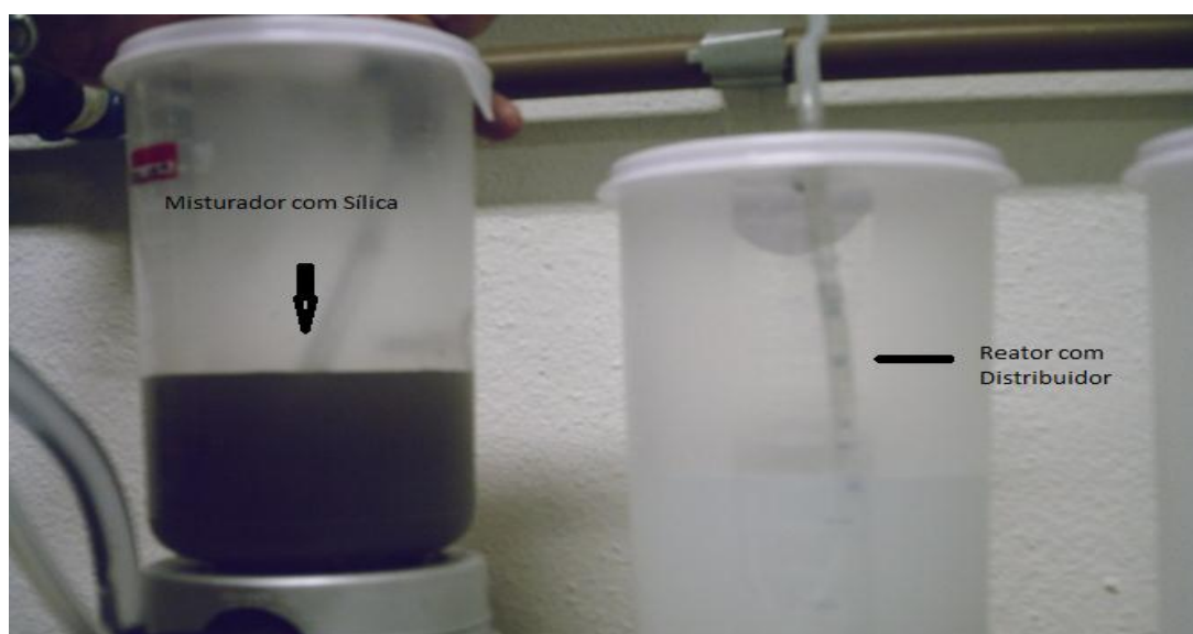
Figura 23 (a): Início do processo, misturador já possui uma carga de água residuária e a mistura é transportada deste para o reator 1 com uso do distribuidor
