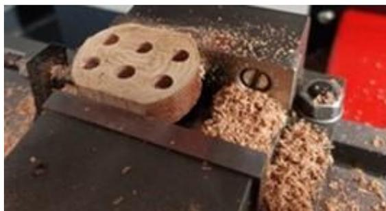
Fig. 6. Cavaco obtido do ensaio de furação com a broca de aço rápido do polímero Celeron. Fonte: próprio autor (2022).
