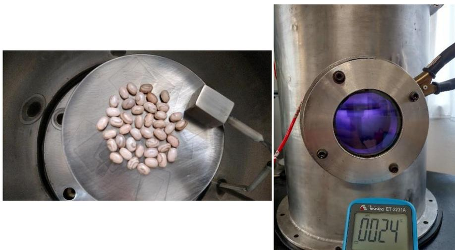
Figura 3 – À esquerda, grãos de feijão sendo acondicionados no eletrodo inferior do reator a plasma, que pode ser visto à direita em funcionamento e com monitoramento de temperatura.
