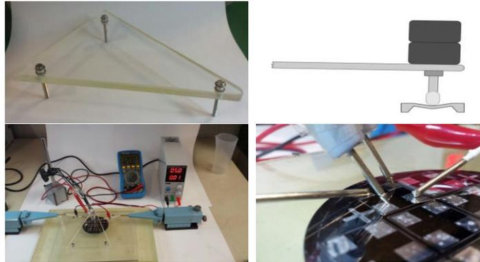
Fig. 9. Arranjo experimental para medição da ddp dos micros sensores na ponte de Wheastone.
