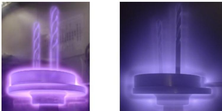
Fig. 2. Tratamento de superfície: (a) limpeza por ablação a plasma da superfície da ferramenta e (b) deposição do filme DLC. Fonte: próprio autor (2022).
