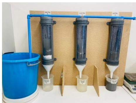
Fig. 1 – Sistema de lixiviação colunar utilizado na filtração dos resíduos
