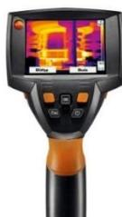
Figura 2. Câmera termográfica Testo<sup>®</sup> 880.
