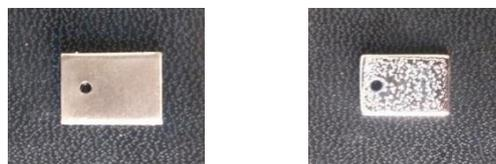
Figura 5 – Amostra antes da anodização (esquerda) / Amostra após a anodização (direita)
