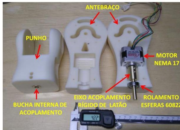
Fig. 5 – Vista interna do conjunto antebraço e punho do robô ROBOTEC mostrando o eixo de acoplamento modificado, entre o motor e bucha interna do punho.
