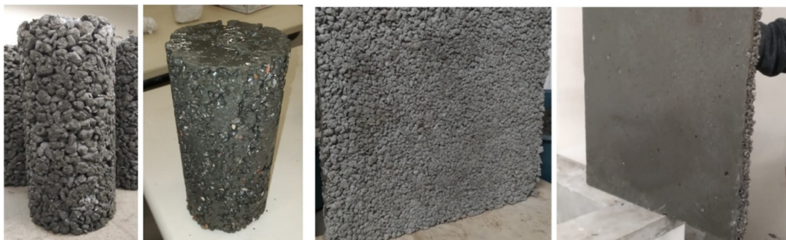
Figura 2 –Comparação dos corpos de provas com brita 0 e RCD
