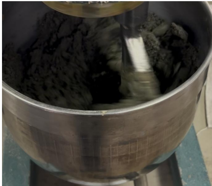
Figura 6 – UHPC na argamassadeira (consistência granulada)
