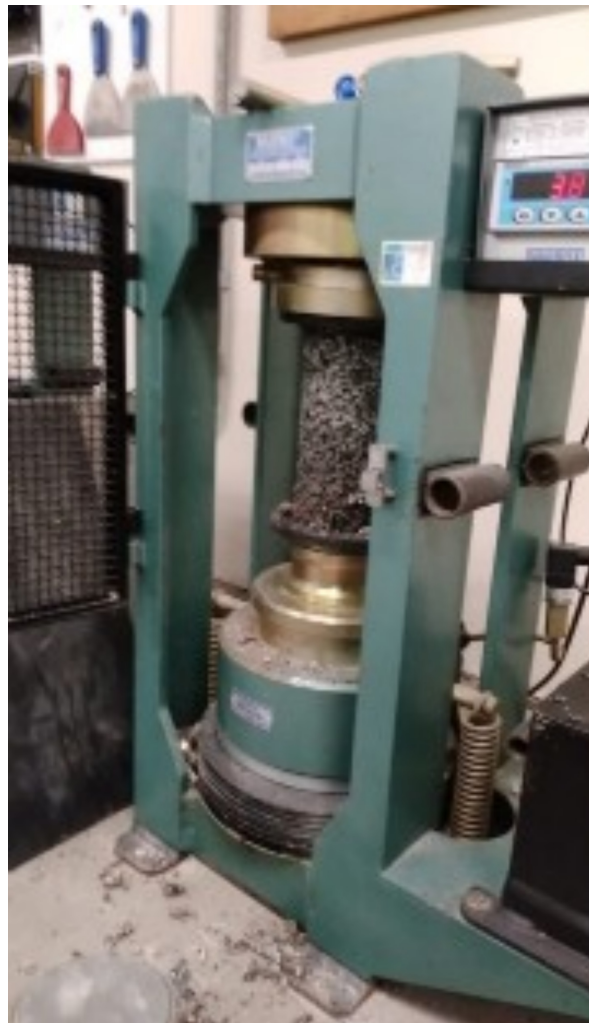
Figura 4 – Ensaio de resistência do concreto com RCD
