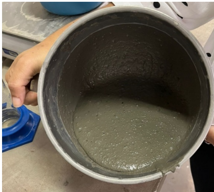
Figura 7 – UHPC na argamassadeira (consistência fluida)
