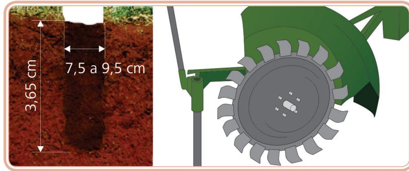
**Figura 4.11: Detalhe do *mulching* vertical e da valetadora rotativa utilizada para construção**
