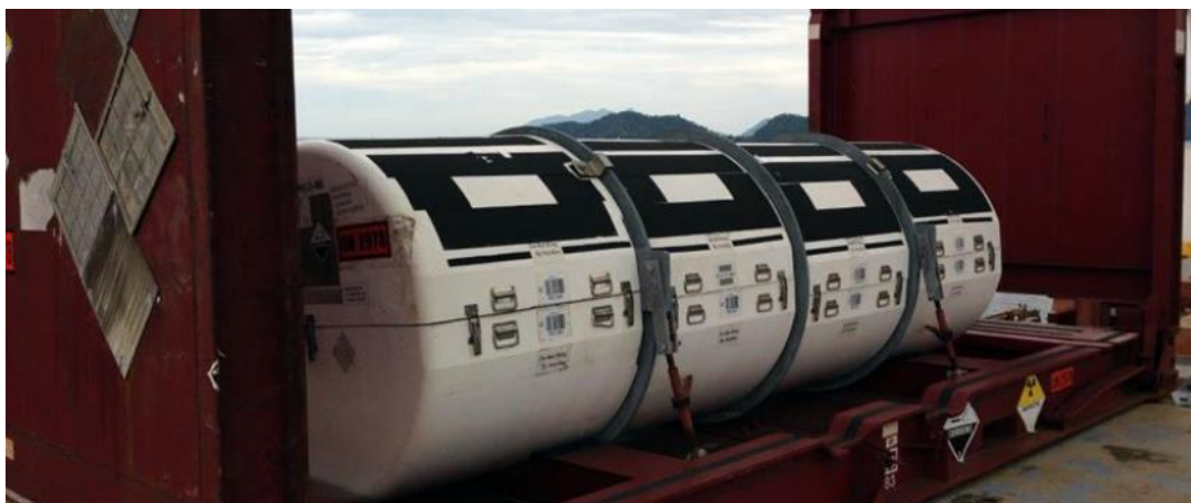
Figura 2: Tanque de Hexafluoreto de Urânio aguardando uso na instalação de Enriquecimento em Resende – RJ
