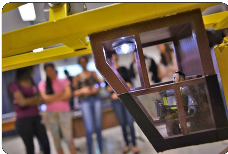
Figura 3 - Cabine do guindaste.
