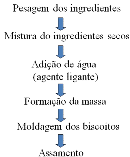
Figura 1. Fluxograma do processo de fabricação do biscoito
