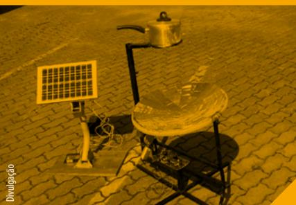
Desenvolvido por estudantes da Etec Jaraguá, o Solar Beam é um fogão solar de alta eficiência, com sistema indutivo removível e retroalimentação fotovoltaica. Uma opção mais barata e mais sustentável do que
